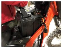
Step 2: Open the front battery plate 打开电池仓内的前挡板
